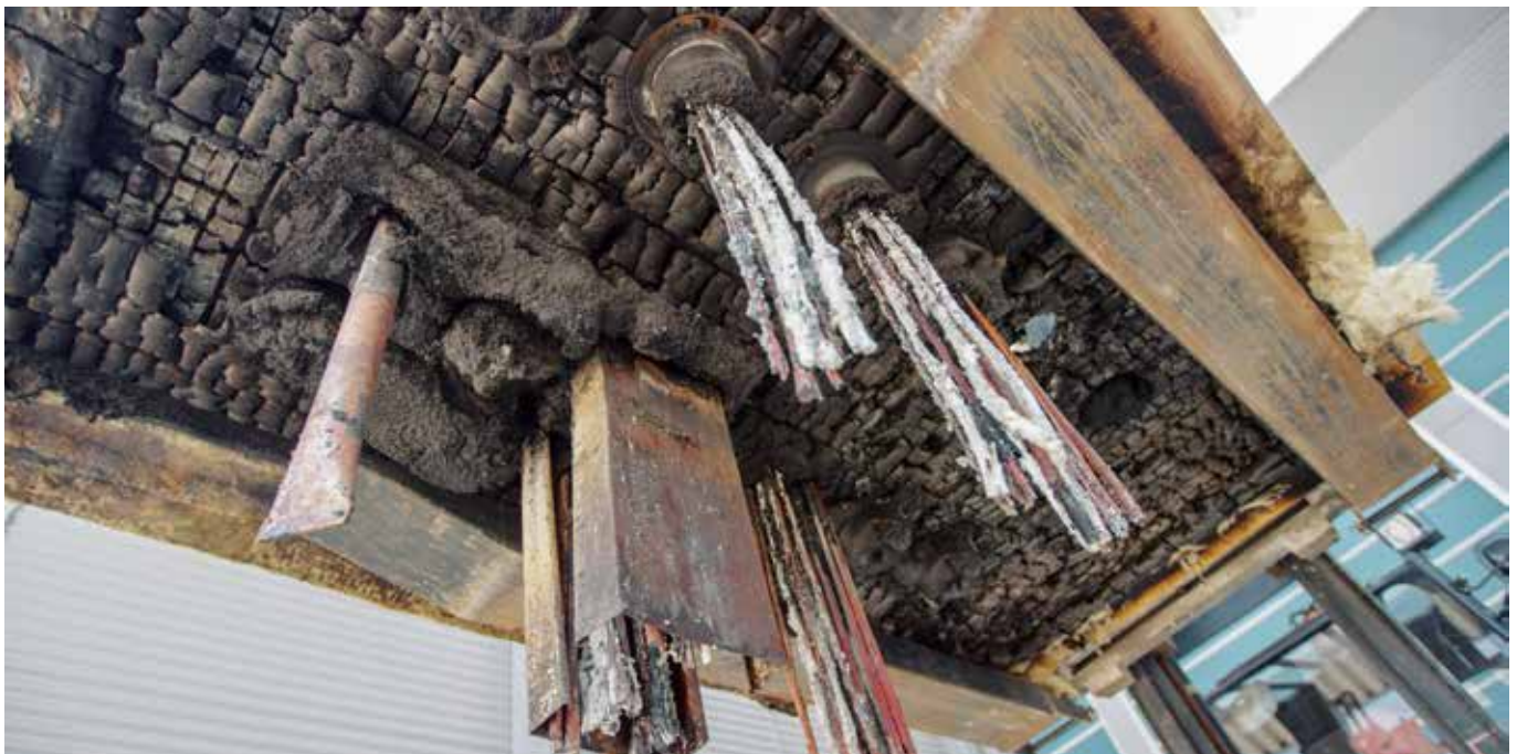
Brettsperrholz-Prüfkörper nach einer Feuerwiderstandsprüfung nach EN1366-3
