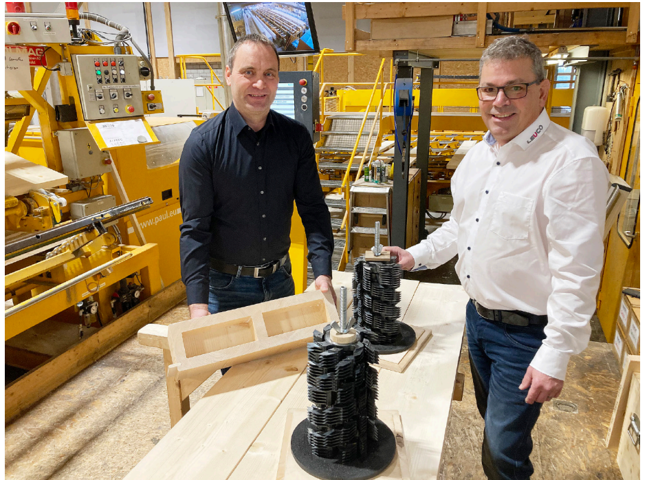
Georg Jost, Produktionsleiter Lignatur AG (links) und Daniel Livet, Aussendienst Leuco, begutachten die Keilzinkenfräsen, welche soeben vom Schärfen zurückgekommen sind.
